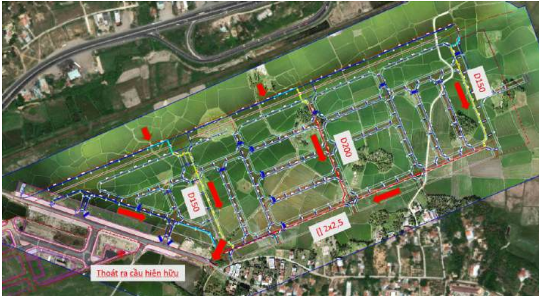
Hình 1.9. Hướng thoát nước mưa dự án
